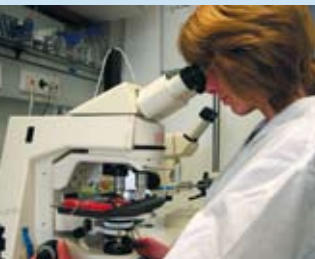
Fertigung und Prüfung der Mikrosensoren unter dem Lichtmikroskop
