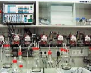
Fermenter zur Aufzucht von Schwefel-oxidierenden Bakterien
