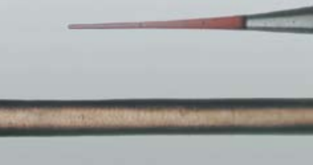
Ein Mikrosensor im Vergleich zu einem menschlichen Haar
