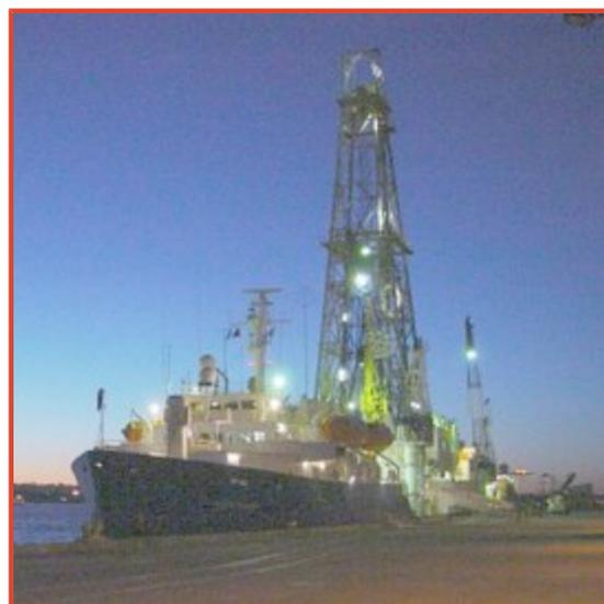
Das Forschungsschiff JOIDES Resolution mit einem 63 m hohen Turm, der die
